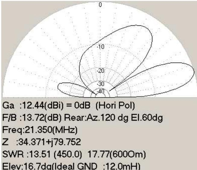
Fig..4 Vertikaldiagramm für 15 m Band
