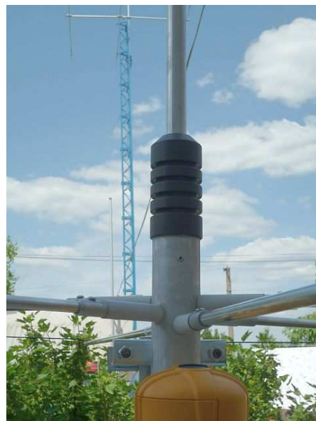
Obr. 3 a 4: Pohled na vertikál OC (s radiály a obvodovým lankem) zespu a pohled na plastový izolátor
