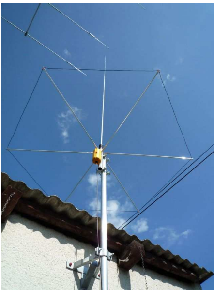
Obr. 3 a 4: Pohled na vertikál OC (s radiály a obvodovým lankem) zespu a pohled na plastový izolátor
